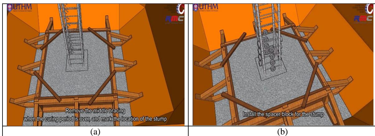
Rajah 4: Proses (a) penandaan saiz dan ukuran untuk stump serta (b) Pemasangan untuk spacer block sisi
