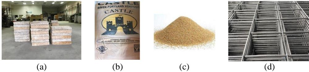
**Figure 1: (a) wwcp (b) Portland cement (c) fine sand (d) Fabric wire mesh A6**
