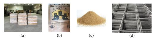
Figure 1: (a) wwcp (b) Portland cement (c) fine sand (d) Fabric wire mesh A6
