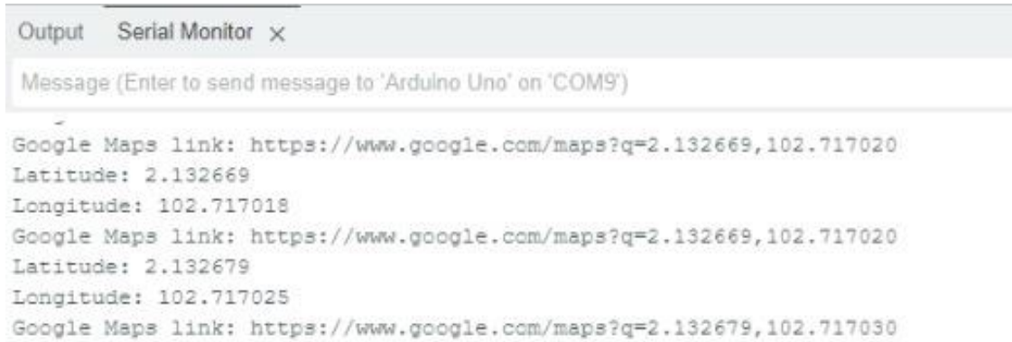
Fig. 4 GPS latitude and longitude of the GPS module at Pagoh Jaya
