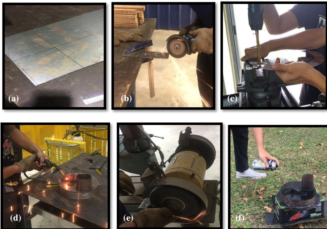
Rajah 3: Fabrikasi (a) Proses mengukur (b) Pemetongan (c) Menebuk dan menggerudi (d) Proses kimpalan (e-f) Kemas
