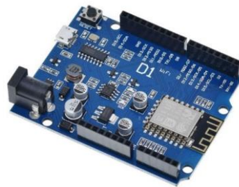
Rajah 1: ESP8266 Wemos D1 Wifi microcontroller
