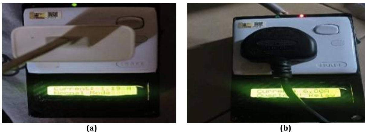
Rajah 5 Keputusan (a) beroperasi normal dengan nilai bacaan LCD dan LED hijau; (b) keadaan lebih beban' dengan bacaan arus lebih serta LED merah diaktifkan
