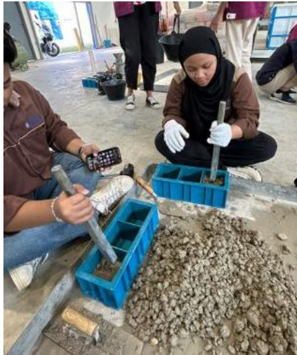
Rajah 2 Proses menuang campuran konkrit ke dalam acuan
