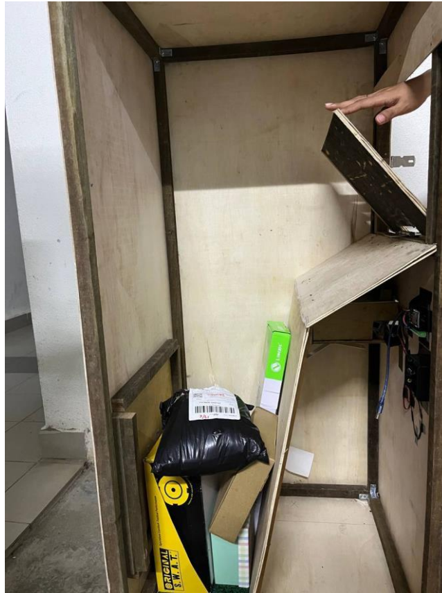
Rajah 3 Ujian one-way insert : tangan tidak mampu untuk mencapai bungkusan
