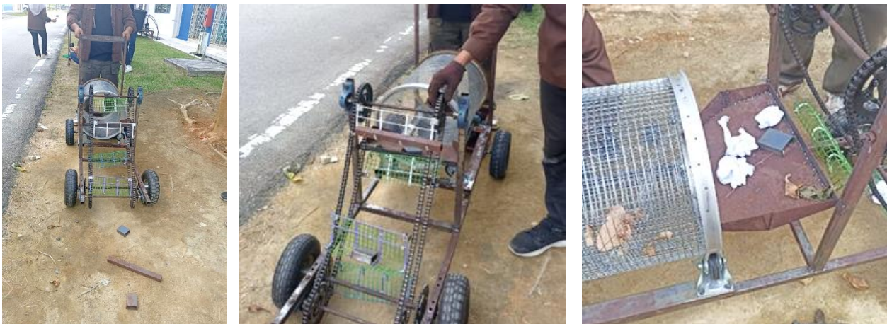
Rajah 6 Pengujian rekabentuk tong penapis
