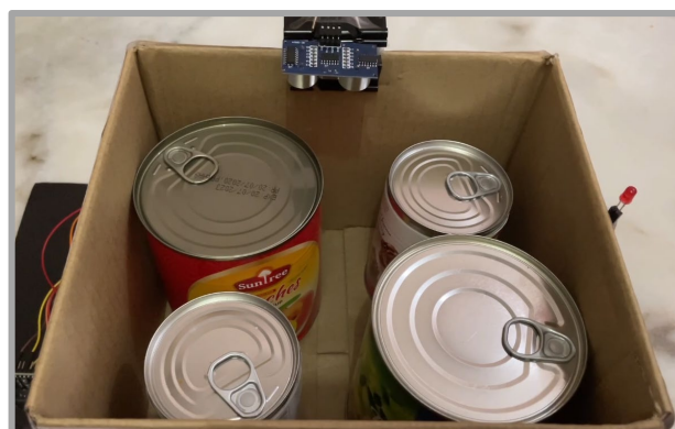
Rajah 24: Simulasi Sensor (tahap penuh tong sampah kurang 80 peratus)
