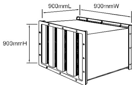
Fig. 3 - Discharge silencer
