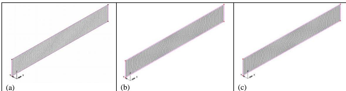
**Fig. 6 - Pattern of shear buckling (a) eigenvalue 1 (b) eigenvalue 2 (c) eigenvalue 3**
