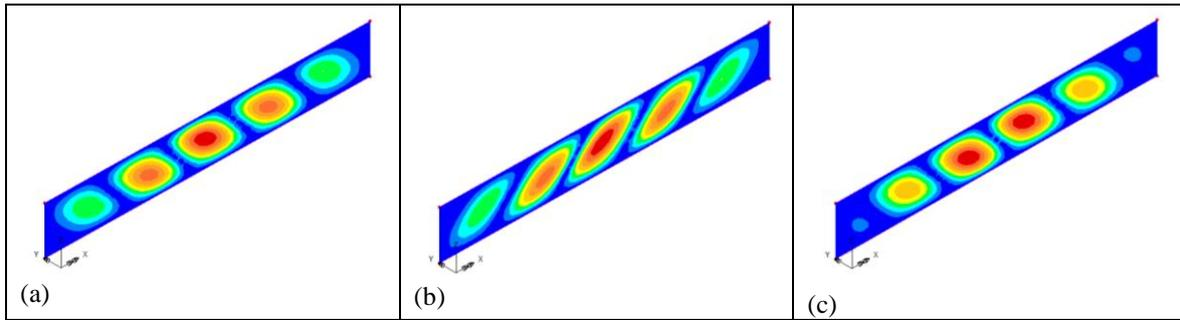
**Fig. 7 - Local shear buckling (a) eigenvalue 1 (b) eigenvalue 2 (c) eigenvalue 3**
