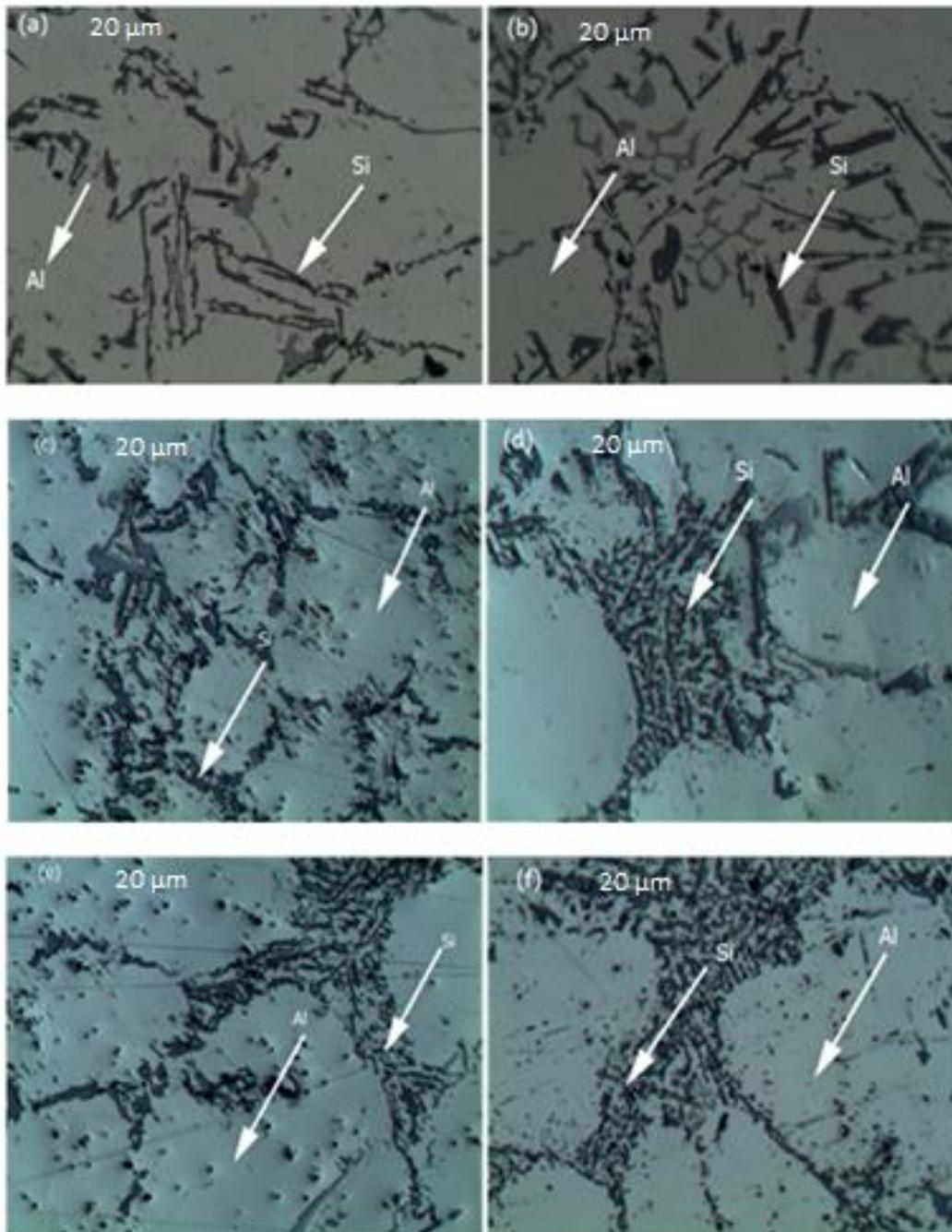
**Fig. 6 - Optical microstructure image of (a) Base alloy; (b) 0.3 wt.% Ce, Er; (c) 0.5 wt.% Ce, Er (d); 0.8 wt.% Ce, Er; (e) 1.0 wt.% Ce, Er; (f) 1.5 wt.% Ce, Er**
