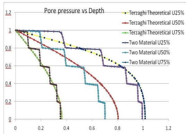
Fig. 7 Pore Pressure Isochrones.
