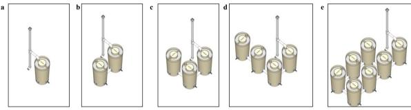
Fig. 5 - a) Single tank; b) twin tank; c) triplet tank; d) quadruplet tank; e) septuplet tank
