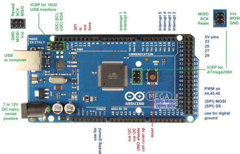
Fig. 1 - Arduino Mega 2560
