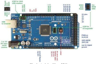
Fig. 1 - Arduino Mega 2560
