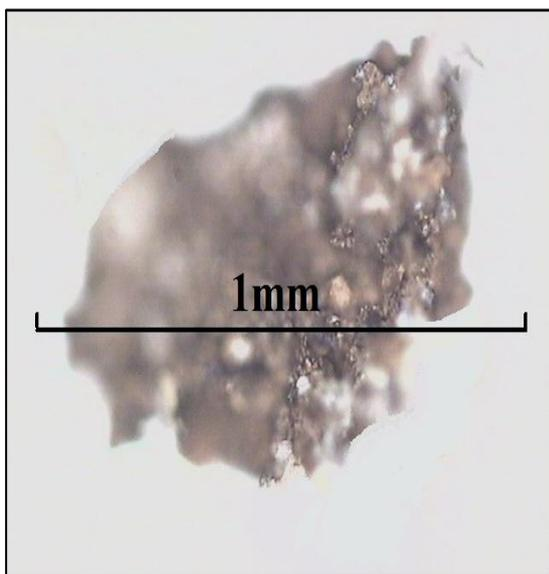
Fig. 3 Sludge granule image.
