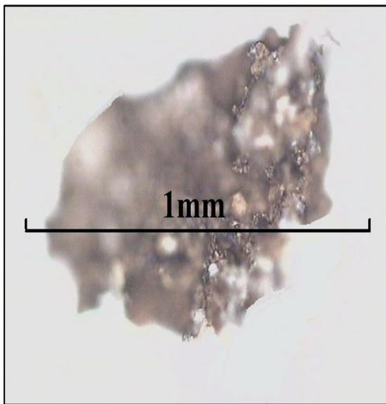
Fig. 3 Sludge granule image.
