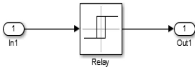
**Fig. 2 – Thermostat subsystem**
