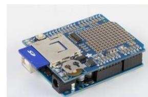
Fig. 10 Data logger module
