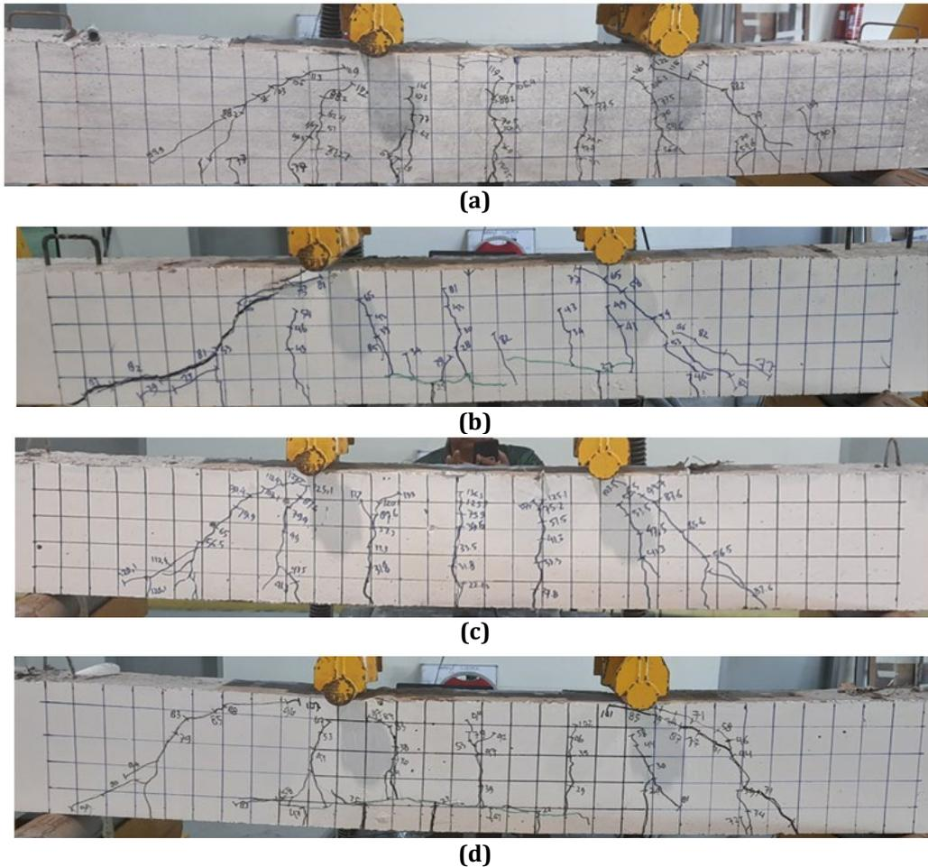
**Fig. 9** Crack pattern of specimens (a) UB1; (b) CB1; (c) UB2; (d) CB2
