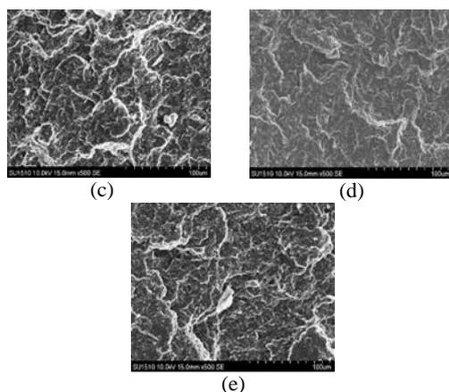
**Fig. 2** Scanning electron microscope images of (a) PP (b) PP/UK (c) PP/TK (1 phr) (d) PP/TK (3 phr) (e) PP/TK (5 phr) at 500× magnification.
