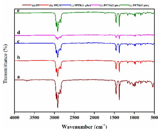
**Fig. 1** FTIR spectra of (a) PP (b) PP/UK (c) PP/TK (1 phr) (d) PP/TK (3 phr) (e) PP/TK (5 phr)
