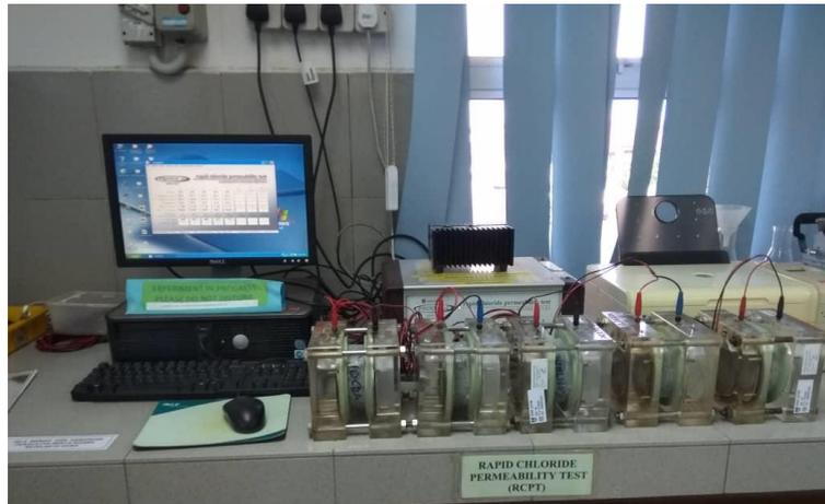
**Fig. 6 - RCPT apparatus arrangements**
